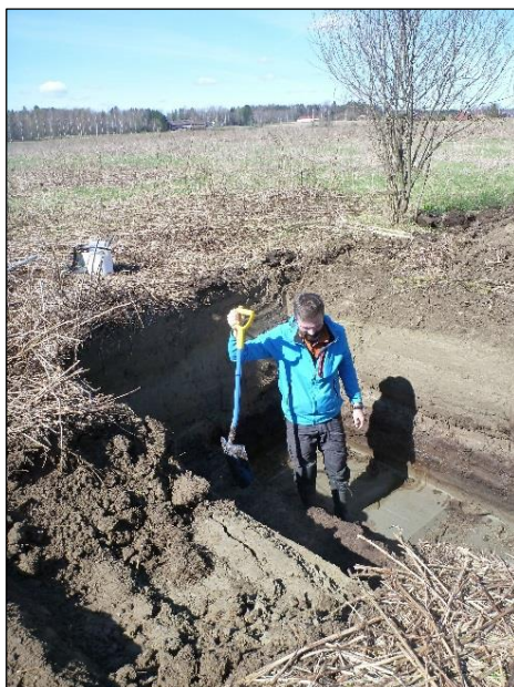
Tiainen varmistaa jotain havaittua hakoja kaivamalla esiin lapiolla. Kuopan pohjaa tutkittiin syvemmälle kasikairauksella.
