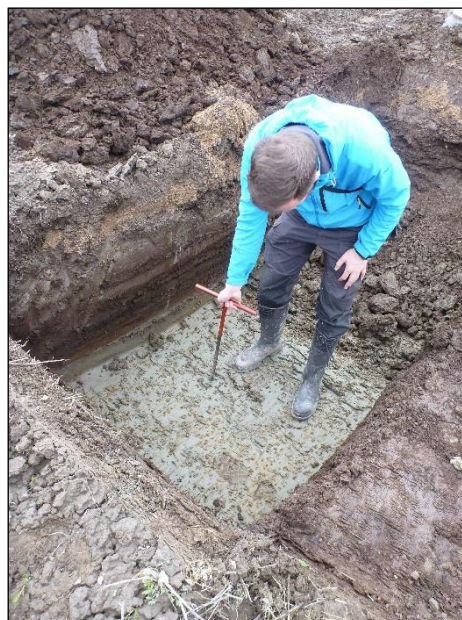
Tiainen varmistaa jotain havaittua hakoja kaivamalla esiin lapiolla. Kuopan pohjaa tutkittiin syvemmälle kasikairauksella.
